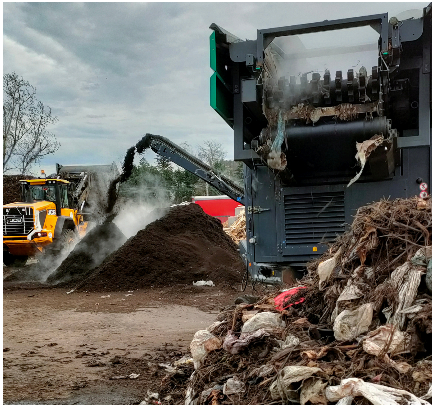
Tri mécanique : au fond à gauche le compost trié, devant à droite les indésirables qui ont été extraits
